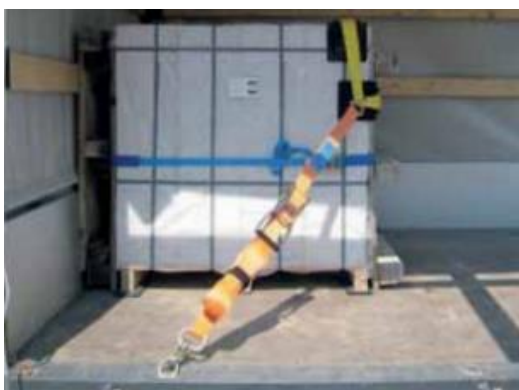
Schrägzurren (Quelle: BG Bau)
