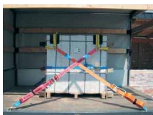
Diagonalzurren (Quelle: BG Bau)
